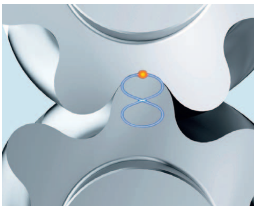
Kuggprofilen ger ständig kontakt vilket gör att vätskan transporteras nästan kontinuerligt och ljudlöst utan instängd olja.
